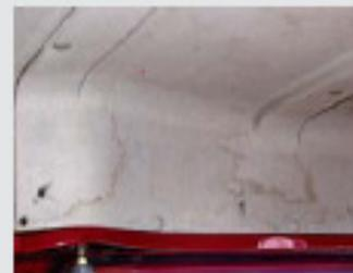
Kassettenhimmel ist im Material verformt, eingerissen oder stark verschmutzt.
