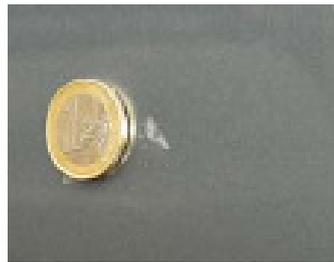
Beulen oder Dellen, auch mit Beschädigungen in der Lackschicht, wenn der Durchmesser nicht mehr als 20 mm = Größe einer 1-Euro-Münze beträgt.
