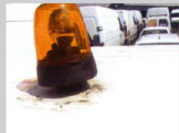
Installierte Warnlampen oder Rundumleuchten, die Glasbruch aufweisen oder nicht korrekt befestigt sind. Die Leuchten entsprechen nicht der StVZO oder sind in der Funktion eingeschränkt.
