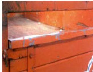
Abrieb auf der Ladekante von Ladeflächen oder Bordwänden, wie sie beim Be- und Entladen von Gütern entsteht.
