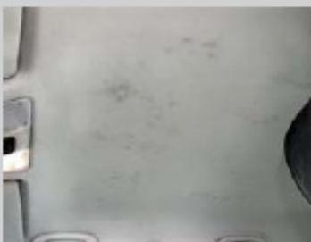
Der Fahrzeughimmel ist verschmutzt. Die Verschmutzung ist nicht nur auf der Oberfläche und durch eine herkömmliche Reinigung nicht zu beseitigen. Gespannter Himmel ist im Material oder in den Nähten aufgerissen.
