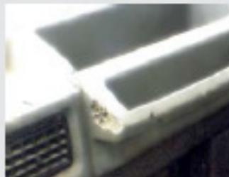
Das Armaturenbrett weist starke Beschädigungen auf. Das Oberflächenmaterial ist beschädigt oder Material ist ausgebrochen.
