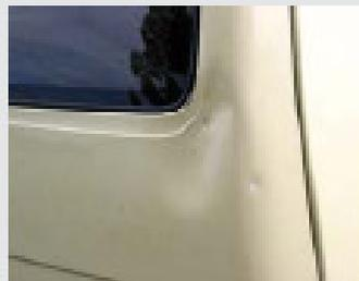
... mit oder ohne Beschädigung des Lackes. Der Durchmesser der Verformung überschreitet die 20-mm-Grenze.
