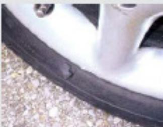
Reifen mit Beschädigungen aufgrund äußerlicher Einwirkung, wie sie üblicherweise durch Überfahren von Bordsteinen hervorgerufen werden.
