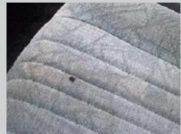
Die Polsterung ist durch Brandlöcher oder durch Schnitte beschädigt. Die Nutzung ist durch deutlich wahrnehmbare Gerüche eingeschränkt.
