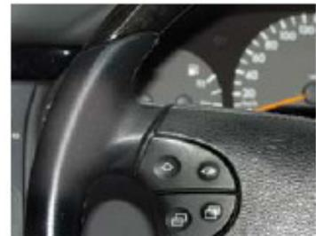
Das Lenkrad ist durch Nutzung abgegriffen. Es sind deutliche Spuren zu sehen, jedoch ist kein Material ausgebrochen.
