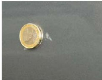
Dellen, auch mit Beschädigungen in der Lackschicht, wenn der Durchmesser 20 mm = Größe einer 1-Euro-Münze nicht überschreitet.
