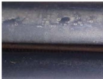
Verfärbungen durch äußere Einflüsse wie Witterung und Streusalz, so weit sie nicht durch falschen Einsatz von Chemikalien entstanden sind.
