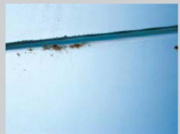
Dellen, Beulen oder Kratzer mit Lackbeschädigungen, die bis zum Grundmaterial reichen und/oder Rostansatz aufweisen.
