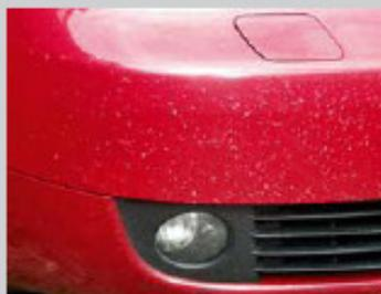
Steinschläge, die mehr als  $\frac{1}{4}$  eines Bauteils bedecken, oder wenn sie durch die Lackschicht bis auf das Grundmaterial gehen.
