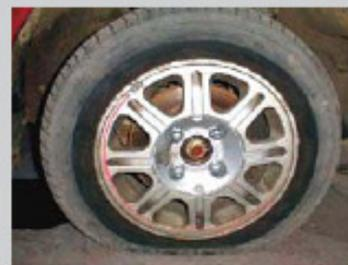
Reifen ohne dauerhaften Luftdruck – unerheblich, ob durch Beschädigung oder Eindringen von Fremdkörpern. Alle Schäden, die die Fahrsicherheit beeinträchtigen.
