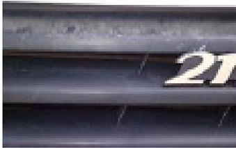
Kratzer oder Schrammen mit einer maximalen Länge von 100 mm. Bei einem lackierten Grill dürfen die Kratzer oder Schrammen nicht bis auf das Basismaterial durchgehen.
