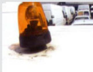
Installierte Warnlampen oder Rundumleuchten, die Glasbruch aufweisen oder nicht korrekt befestigt sind. Die Leuchten entsprechen nicht der StVZO oder sind in der Funktion eingeschränkt.
