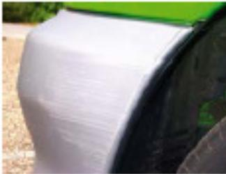
Leichte Kratzer oder Schrammen bis zu einer Tiefe von 1 mm. Bei einem lackierten Stoßfänger dürfen diese nicht bis auf das Basismaterial durchgehen.
