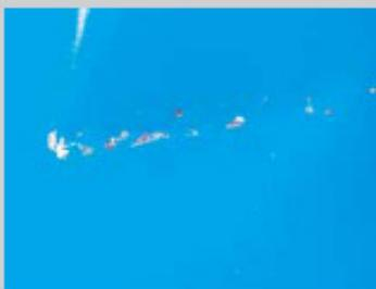
Schrammen und Kratzer, die durch die Lackschicht gehen oder mehr als zwei Schrammen oder Kratzer auf einem Bauteil.
