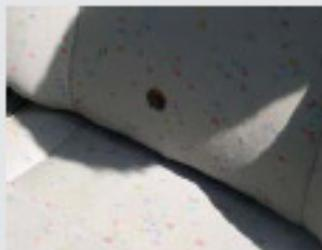
Die Polsterung ist durch Brandlöcher oder durch Schnitte beschädigt. Die Nutzung ist durch deutlich wahrnehmbare Gerüche eingeschränkt.
