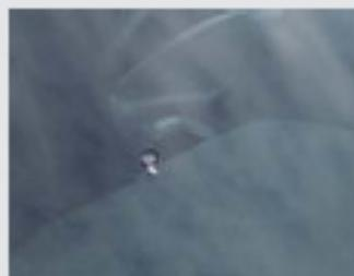
Einschläge in der gesamten Fläche der Windschutzscheibe, die mindestens die äußere Glasschicht beschädigen. Ebenso Steinschläge, die bei technischen Überprüfungen (§ 29 StVZO) nicht abgenommen werden.
