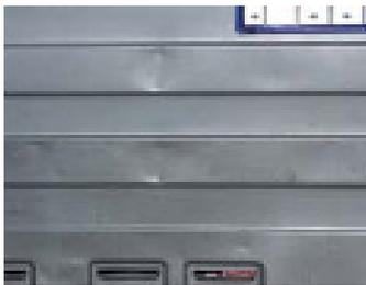
Dellen oder Beulen in Trennwänden, wie sie durch Transport sowie das Be- und Entladen von Gütern entstehen und keine Funktionen im Lade- oder Passagierraum beeinträchtigen.
