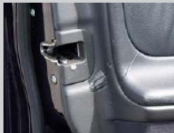
Die Innenverkleidung ist nicht durch Nutzung, sondern durch Fremdeinwirkung beschädigt. Die Türverkleidung weist durch Einklemmen des Sicherheitsgurtes Löcher, Risse oder deutliche Verformungen auf.
