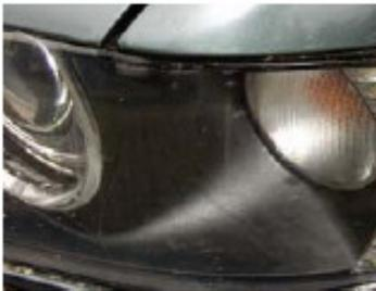
Kratzer, auch Einschläge, in der Oberfläche von Scheinwerfern, Nebelscheinwerfern oder Blinkern, die das Glas nicht brechen und die Funktion nicht einschränken.
