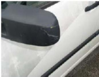
Kratzer oder Schrammen mit einer maximalen Länge von 50 mm, die bei lackierten Spiegeln nicht durch die Lackierung gehen. Bei unlackierten Spiegeln dürfen Kratzer oder Schrammen nicht bis auf das Basismaterial durchgehen. Die Funktion darf nicht eingeschränkt sein.
