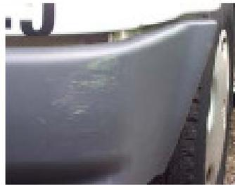
Kratzer oder Schrammen bis zu einer Tiefe von 1 mm und einer Fläche von maximal 90 x 100 mm, die bei einem lackierten Stoßfänger nicht durch die Lackierung gehen.
