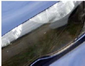
Steinschläge in der Oberfläche von Scheinwerfern, Nebelscheinwerfern oder Blinkern, die das Glas nicht brechen und die Funktion nicht einschränken.
