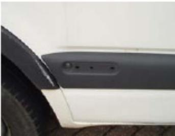
Kratzer in der Lackschicht, die durch Polieren entfernt werden können und daher keine Lackierung notwendig machen.
