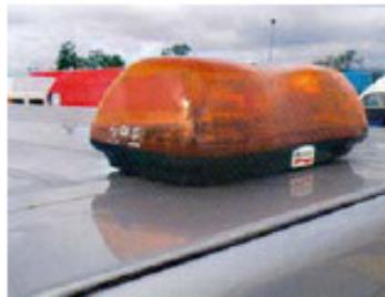
Installierte Warnlampen oder Rundumleuchten dürfen keinen Glasbruch aufweisen, und die Funktion darf nicht eingeschränkt sein. Die Leuchten müssen der StVZO entsprechen und müssen, soweit gesetzlich vorgeschrieben, abgenommen und in die Fahrzeugpapiere eingetragen sein.
