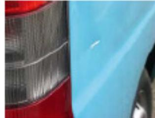
Kratzer oder Schrammen, auch mit Beschädigungen in der Lackschicht, wenn der Durchmesser nicht mehr als 20 mm = Größe einer 1-Euro-Münze beträgt.
