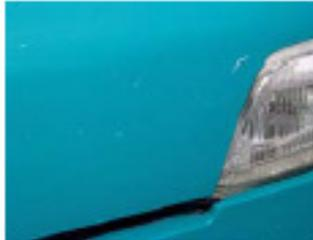
Schrammen oder Kratzer mit einer maximalen Länge von 100 mm.
