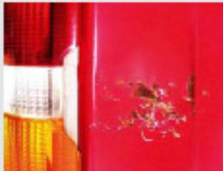
Schrammen und Kratzer, die durch die Lackschicht gehen oder durch ihre Häufung auf einem Bauteil die Optik deutlich beeinflussen.
