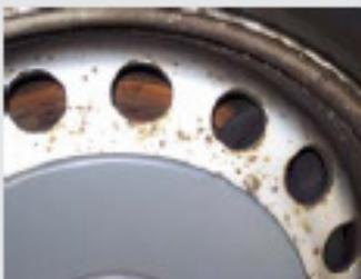
Felgen mit Deformation des Felgenhorns, fehlendem Material oder Rostansatz.
