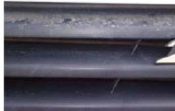
Kratzer oder Schrammen mit einer maximalen Länge von 100 mm, die bei lackierten Stoßfängern nicht durch die Lackierung gehen.
