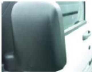
Leichte Kratzer oder Schrammen mit einer maximalen Länge von 50 mm und maximalen Tiefe von 1mm. Die Funktion darf nicht eingeschränkt sein.
