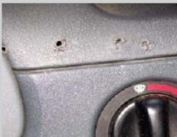
Zubehörhalter, Telefone oder Freisprecheinrichtungen sind ausgebaut worden, die Bohrlöcher sind sichtbar im Fahrer- oder Beifahrerbereich zu sehen.
