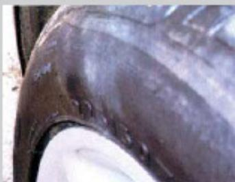
Erkennbare Beulenbildung durch Bruch der Karkasse oder Seitenwand, Risse oder fehlendes Material im Profil oder in der Seitenwand.
