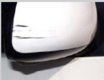
Kratzer oder Schrammen, die eine maximale Länge von 50 mm überschreiten oder bei lackierten Spiegeln durch die Lackierung bzw. bei unlackierten Spiegeln bis auf das Basismaterial gehen.
