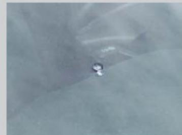
Einschläge in der gesamten Fläche der Windschutzscheibe, die mindestens die äußere Glasschicht beschädigen. Ebenso Steinschläge, die bei technischen Überprüfungen (§ 29 StVZO) nicht abgenommen werden.
