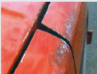
Kratzer, Lackschäden oder starker Abrieb an Karosserieteilen, die nicht zum üblichen Ladebereich des Fahrzeugs gehören. Lackschäden an Dachkanten, wie sie vom unsachgemäßen Be- und Entladen von Dachgepäckträgern entstehen können.
