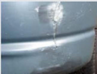
Lackierte Stoßfänger, die Schrammen oder Kratzer bis auf das Basismaterial aufweisen oder durch Fremdeinwirkung Verformungen haben.
