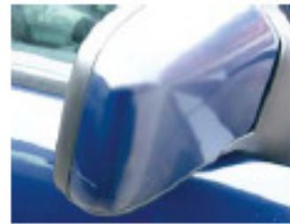
Ist der Außenspiegel lackiert, dürfen leichte Kratzer oder Schrammen mit einer maximalen Länge von 50 mm nicht bis auf das Basismaterial durchgehen. Die Funktion darf nicht eingeschränkt sein.
