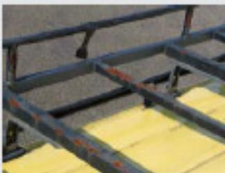
Montierte Dachträger dürfen keinen Bruch aufweisen und müssen korrekt befestigt sein. Der Träger darf nicht durch ins Material eingedrungenen Rost in der Sicherheit beeinträchtigt sein.
