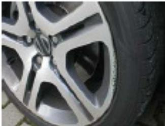
Schrammen, Kratzer oder Ablagerungen an Felgen, wenn die Felgenkante nicht deformiert ist.
