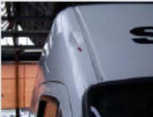
Verformungen der Karosserie, mit oder ohne Beschädigung des Lackes. Der Durchmesser der Verformung beträgt mehr als 20 mm.
