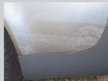
Kratzer, die länger als 100 mm oder an einem Bauteil mehrfach vorhanden sind. Außerdem alle Kratzer, die nicht durch Polieren zu entfernen sind und eine Lackierung erforderlich machen.
