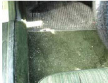
Der Fahrzeug-Teppichboden zeigt Nutzungsspuren. Es sind Abrieb und Verfärbungen zu erkennen.
