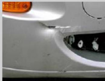
Stoßfänger mit Rissbildungen oder Einschnitten durch Fremdeinwirkung. Fehlende Abdeckungen von Abschleppösen oder abnehmbaren Anhängerkupplungen.
