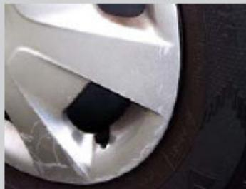
Felgen mit gravierenden Beschädigungen, Deformation des Felgenhorns oder fehlendem Material.
